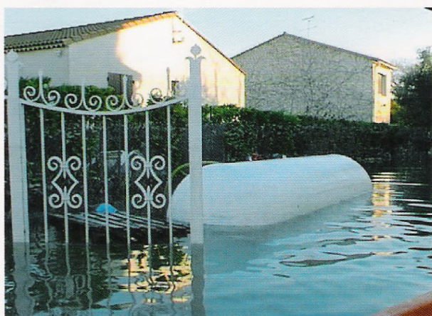
Cuve soulevée par l'eau.
